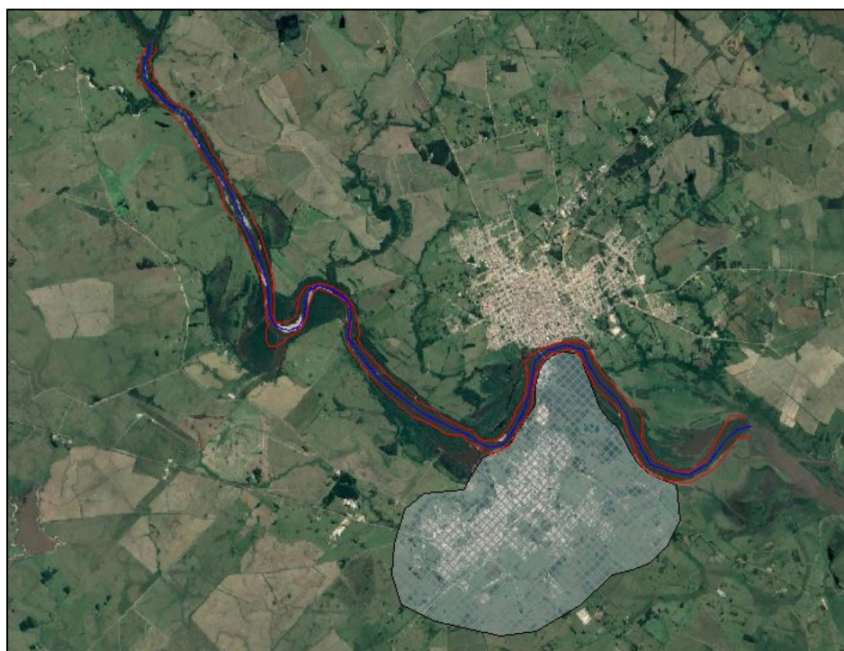
Figura 113. Ejemplo de configuración geométrica del modelo hidráulico 1D/2D acoplado para el río Yaguarón, Uruguay.
